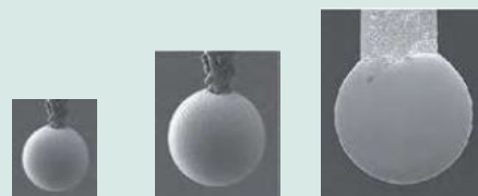
UMAP 101 \phi 15 \mu\text{m} L = 0,2 mm
