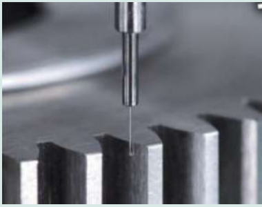
Měření ozubení pomocí MPP-Nano Modul 0,8
